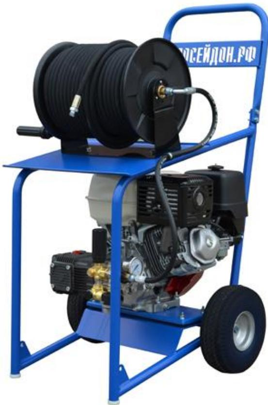
Аппарат высокого давления «Посейдон» модель ВНА-Б-220-22Б производится на базе бензинового двигателя Lifan 190 мощностью 15 л.с. и имеет надежный насос высокого давления Annovi Reverberi (Италия). Компактный и удобный в использовании аппарат с оптимальными рабочими характеристиками для высококачественной профессиональной очистки труб и мойки поверхностей. Профессиональный аппарат для подрядных организаций, ЖКХ, водоканалов и промышленных предприятий.
